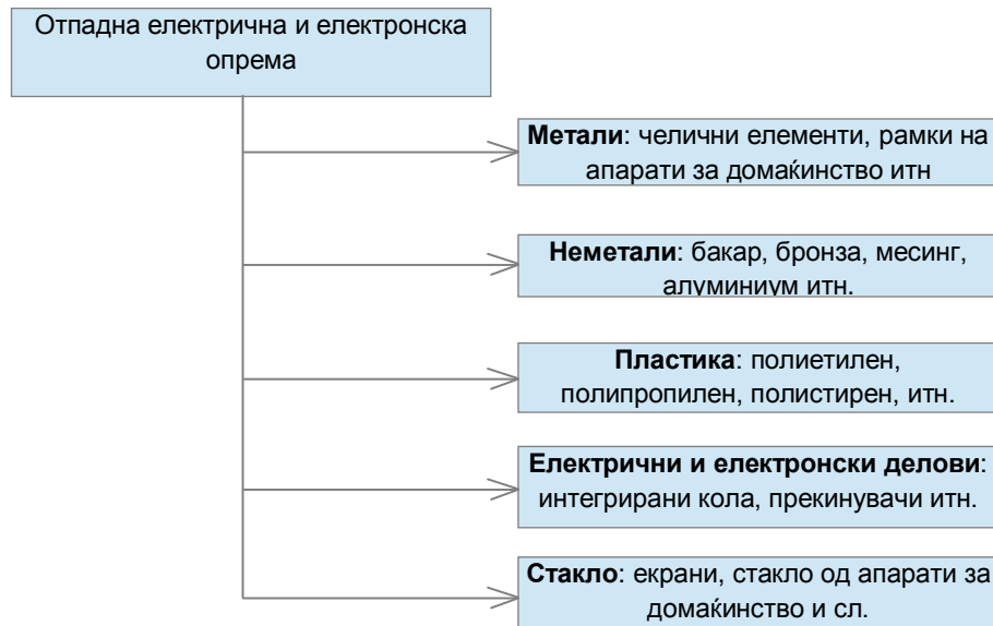
Слика 3 Шематски приказ на добиени материјали од рачно демутирање на ОЕЕО
